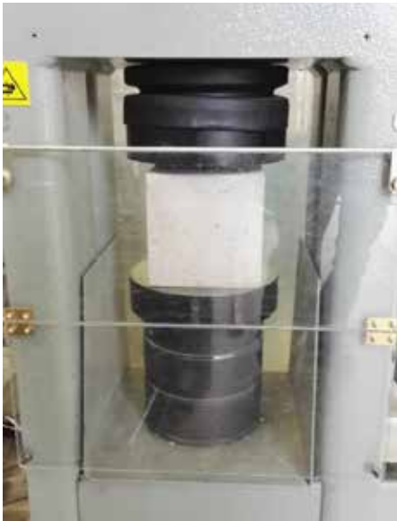
Kuvio 10. Betonikuutioiden koestuslaitteisto
