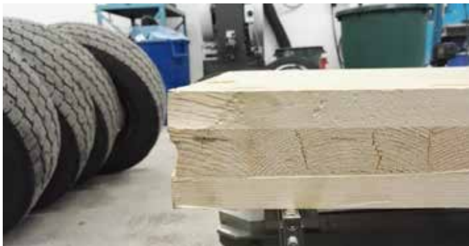
Kuvio 14. CLT-levyn toinen pää taivutuskokeen jälkeen
