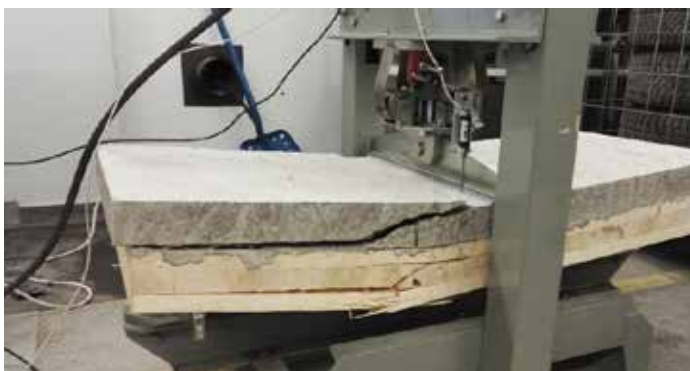
Kuvio 15. CLT-betoniliittorakenne taivutuskokeen päätyttyä
