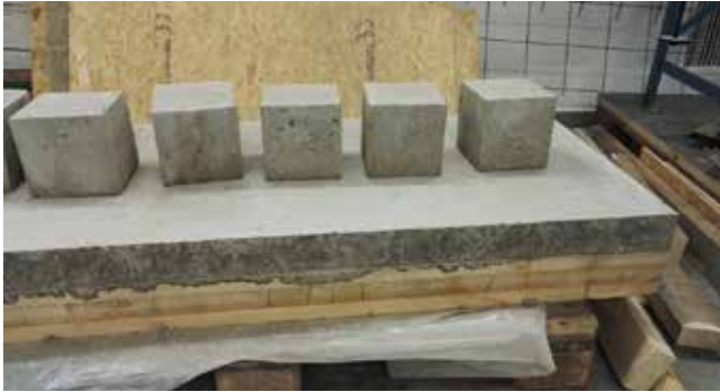
Kuvio 9. CLT-betoniliittorakenne ja koekuutiot
